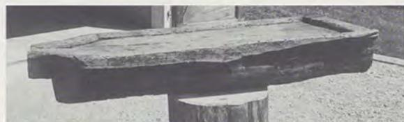
Bohle mit seitlichen Ablaufrinnen für die Käsemilch. Er bietet gewöhnlich Platz für mehrere Greyzer Laibe. Den Druck übt ein mit Steinen beladenes Brett aus. Mit einem Hebel kann die Last leicht angehoben werden und drückt dann über einen eingeschobenen Stab auf das Käse Brett. Modernere Pressen bestehen aus metallenen Schraubzwingen (Abb. 109).
